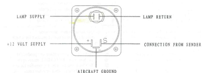
NOTE: SENDING UNIT MUST BE GROUNDED FOR PROPER OPERATION
