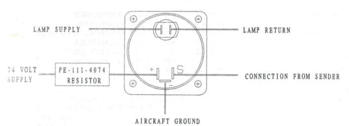
NOTE: SENDING UNIT MUST BE GROUNDED FOR PROPER OPERATION
